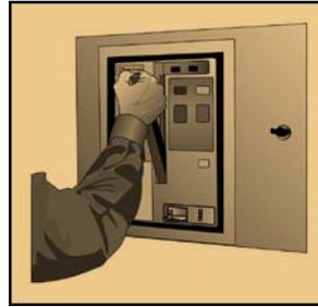
El cierre de interruptor de circuito, una vez cargado el resorte, es rápido y **ocurre dentro de un período de cinco ciclos**. El tiempo de carga de resorte es típicamente de varios segundos.
